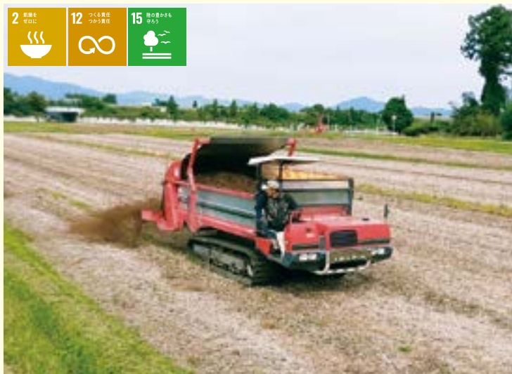
作業効率の良い堆肥散布機（マニアスプレッダー）での作業
