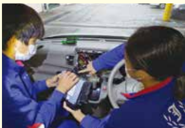
【オートパルなんと】カーナビゲーションの取り外し作業
